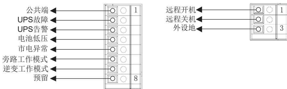
由于机器提供的输出干节点信号为短路和开路两种状态，不提供高低电平信号，因此客户使用需要外接电源。输入干节点不用额外使用电源来驱动，将对应信号与地引脚进行短路或开路即可。
