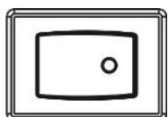
用户可以通过此按钮来进行软体更新操作。正常工作时，开关处于“O”状态，当软体更新时，开关在“1”状态，软件更新完成后开关必须恢复至“O”状态。
