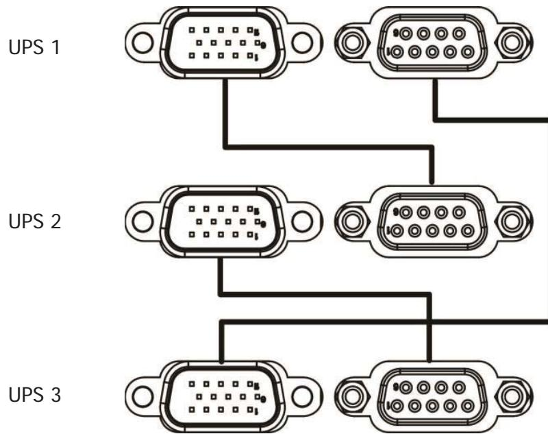
4台并机时，参考3台并机的接线增加多一组功率线及通讯线路完成接线。
